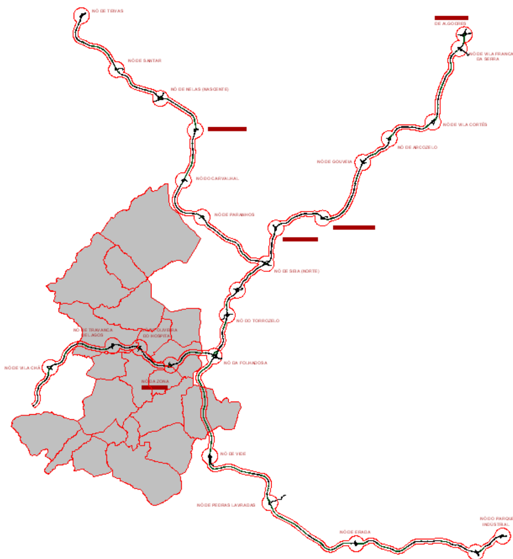
Figura 12 – Zonas de Servidão non aedificandi dos traçados dos IC6, IC7 e IC37, publicadas em Diário da República e sua localização no município de Oliveira do Hospital
